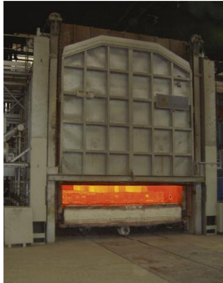
Formung der fünf Vierkant-Stähle für das Kunst-am-Bau-Projekt am Polizeipräsidium in Straubing: Glühofen (s. o.) und hydraulische Gesenkpresse (S. 25) bei PICKHAN Umformtechnik in Siegen
